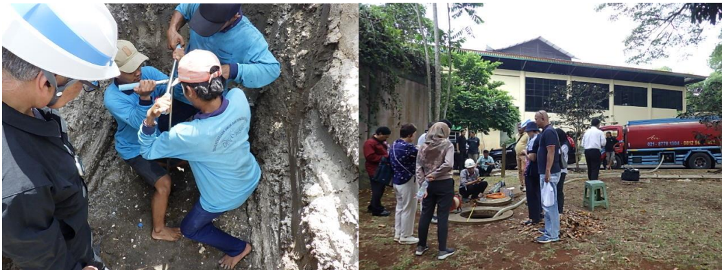
(写真：(左)インドネシアでの土壌掘削調査、(右)注水試験作業 提供/北海道ポラコン(株))
