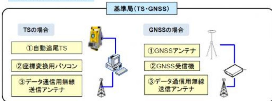
※TSで、計測したデータを「②座標変換用パソコン」を介さずに直接移動局へ伝達可能なもの、「③データ通信用無線送信アンテナ」が内蔵されたものがある。
