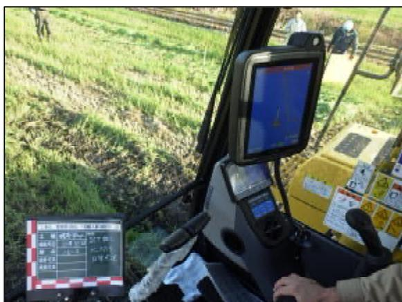
キャリブレーションIMU調整
