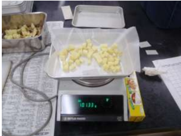
写真 2-2-4 含水率測定状況
