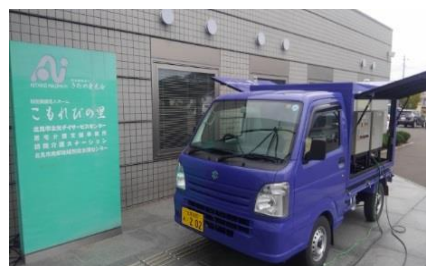
小型移動電源車による福祉施設への給電 (北見の福祉施設)
