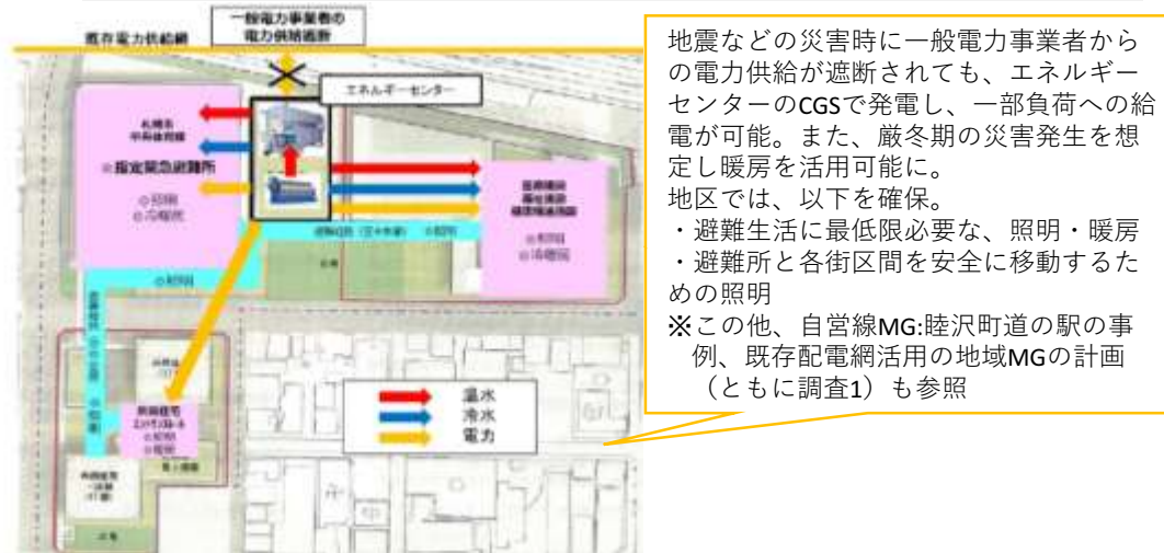
地域での災害対応可能な分散型エネルギーシステム（札幌市）
