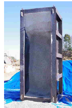
(d) GX-70（粒状ベントナイト70%+ケイ砂30%）の吹付け出来形
