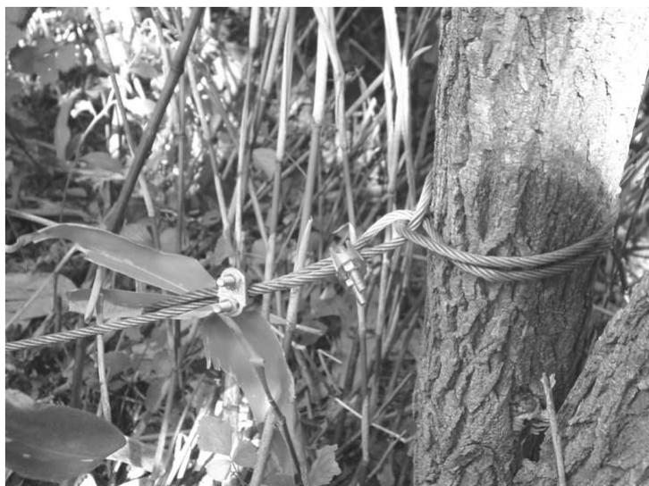
ワイヤーがゆるまないように、D型金具などできっちりと固定します。あまりきつく巻きつけると、ヒグマが暴れたときにワイヤーが固定されて、切れる恐れがあるので、ゆるめに巻きつけます。
