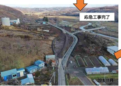
被災前の形状での復旧とはせず、交付金事業との合併施工により 改良復旧を実施(急勾配・急カーブ及び変則的交差点を是正) 【施工中】
