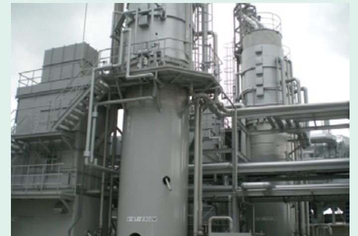
混合溶剤回収装置。混合溶剤の再利用、未利用のVOCの燃料利用は業界初
