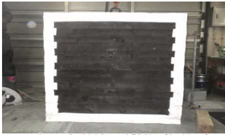
写真1：加熱前の試験体（加熱面）
