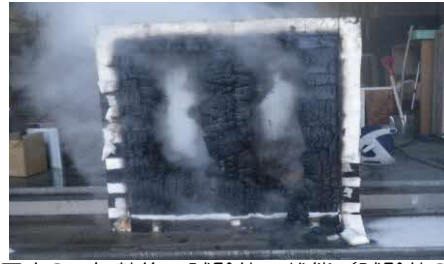
写真2：加熱後の試験体の状態（試験体3）
