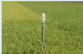
水位等を計測する水田センサー
