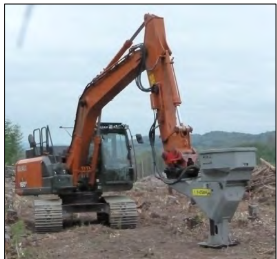
(機械によるコンテナ苗植栽)
