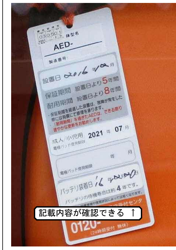
ケースに収納されていても、本体の耐用期間、電極パッドの使用期限及びバッテリーの寿命が記載された表示ラベルが外部から容易に確認できることが分かる
